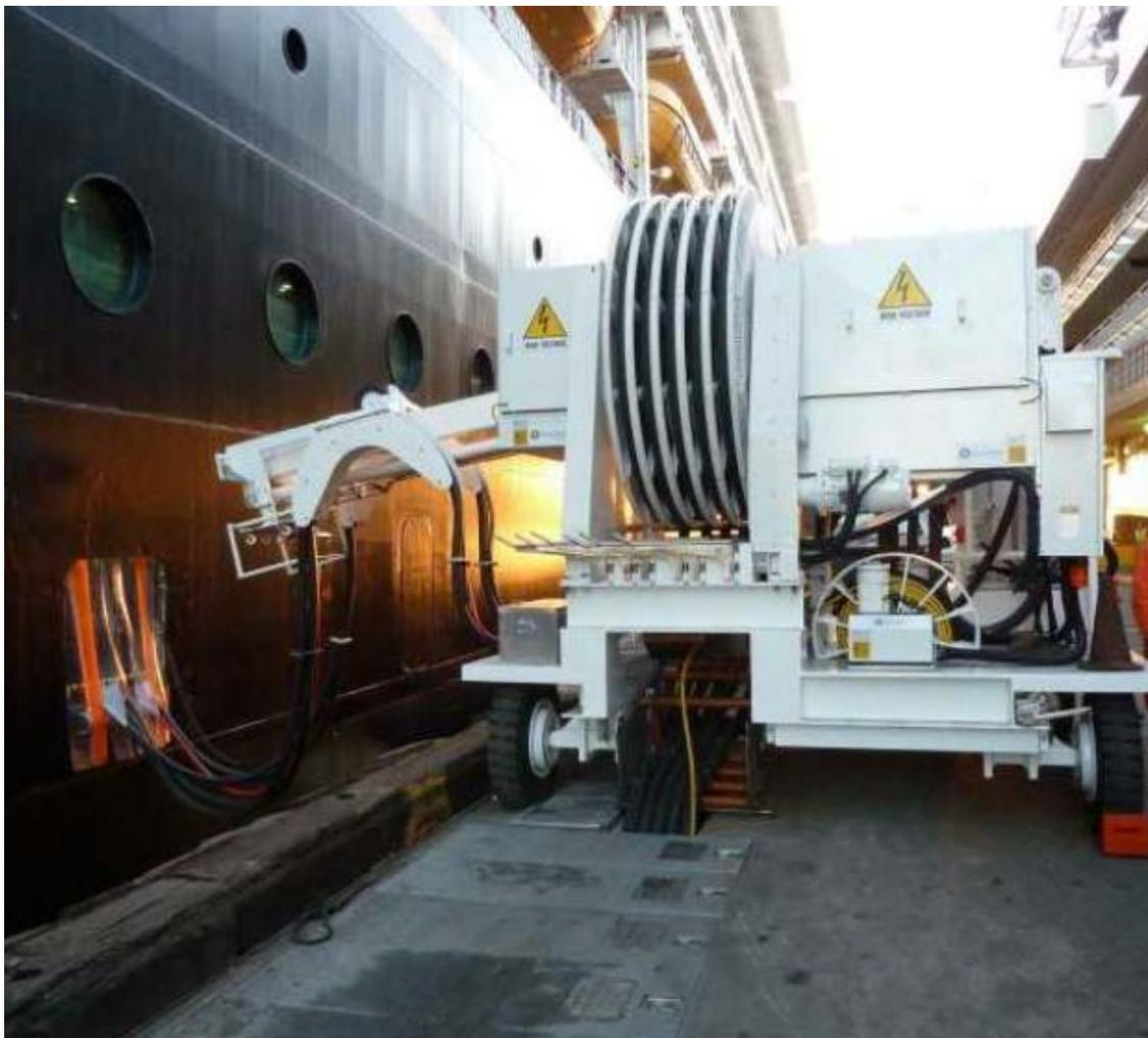
**Figura 23.** Sistema de manejo de cables en el Puerto de Los Ángeles. Fuente: Cavotec.
