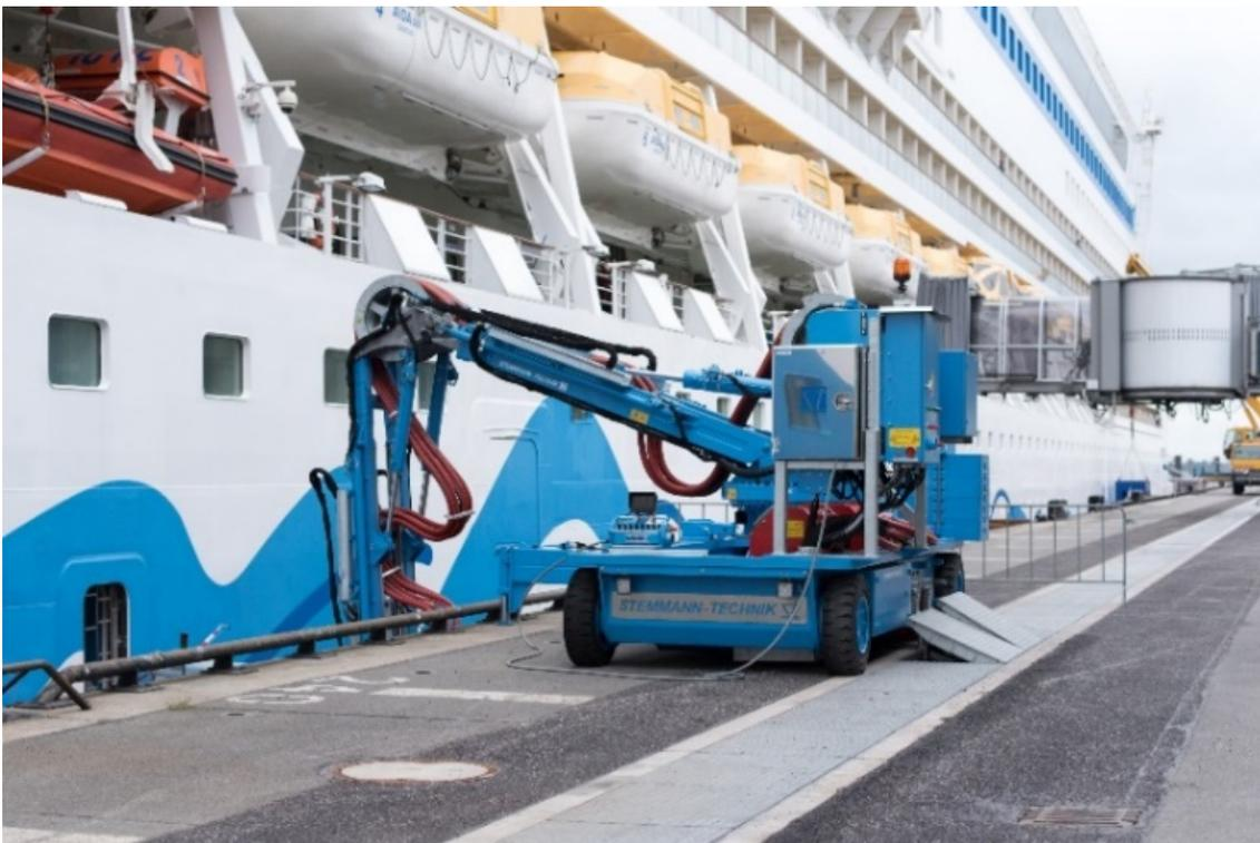
Figura 22. Sistema de manejo de cables en el Puerto de Hamburgo. Fuente: Stemman-Technik.
