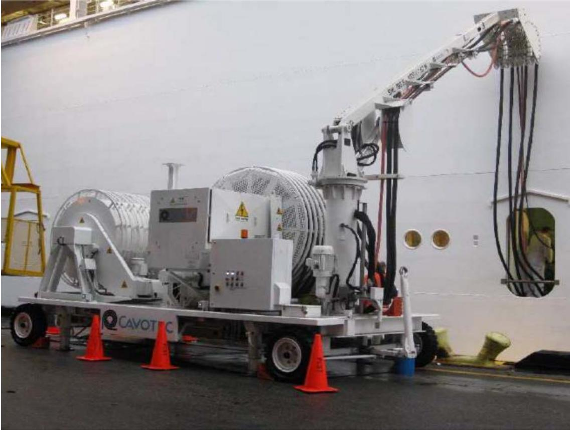
**Figura 14.** Grúa de manipulación de manguera eléctrica para el suministro OPS.
