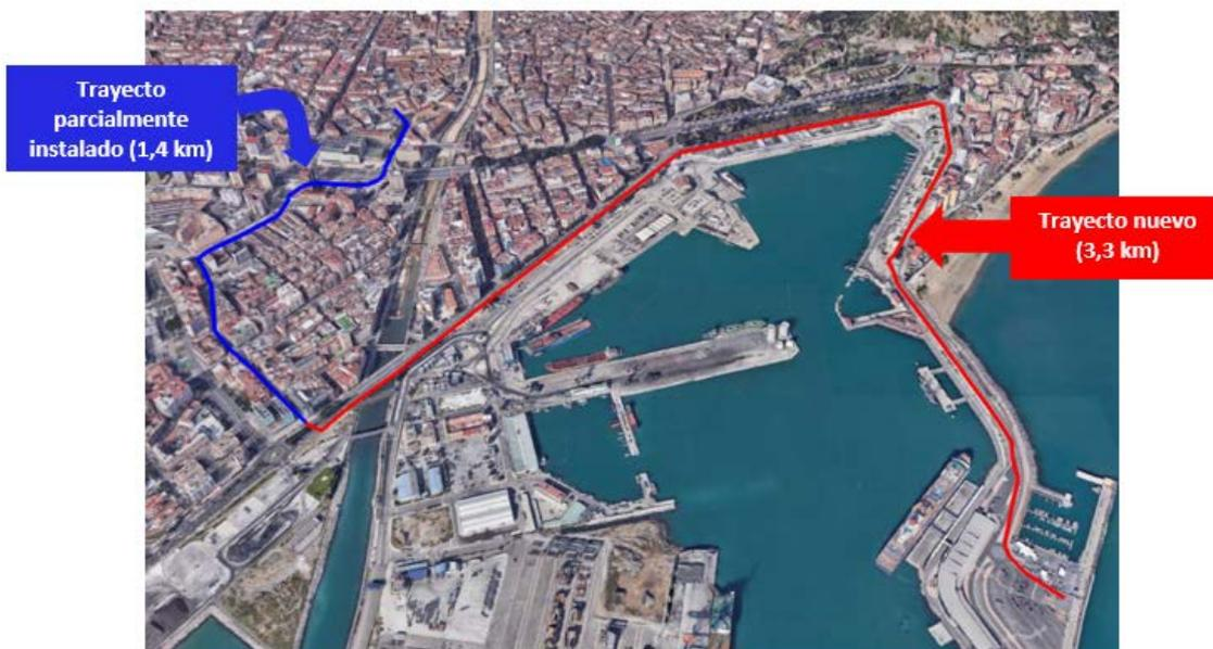
**Figura 18.** Plano de la acometida a la red eléctrica a 66 kV.
