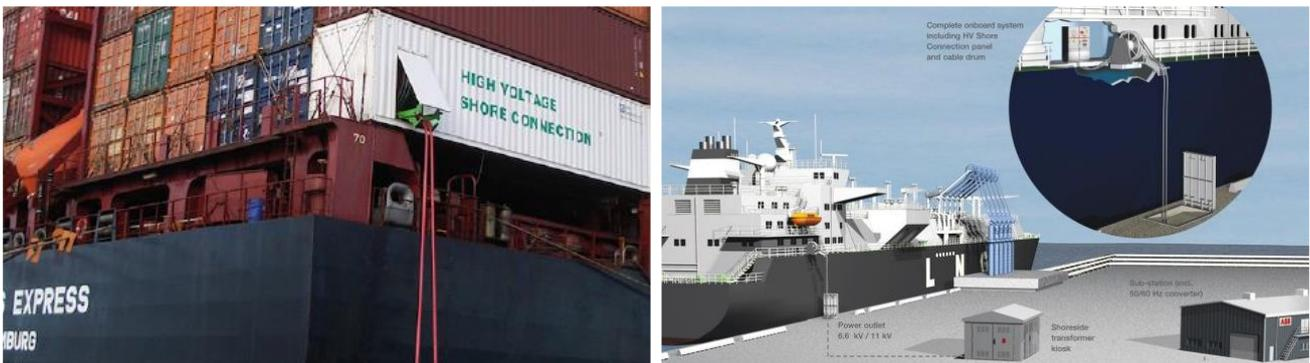
Figura 2. Izda: Dispensador a bordo en un portacontenedores (Fuente: Schneider) y, Dcha: Sistemas de Conexión en Muelle para Buques GNL (Fuente: ABB).
