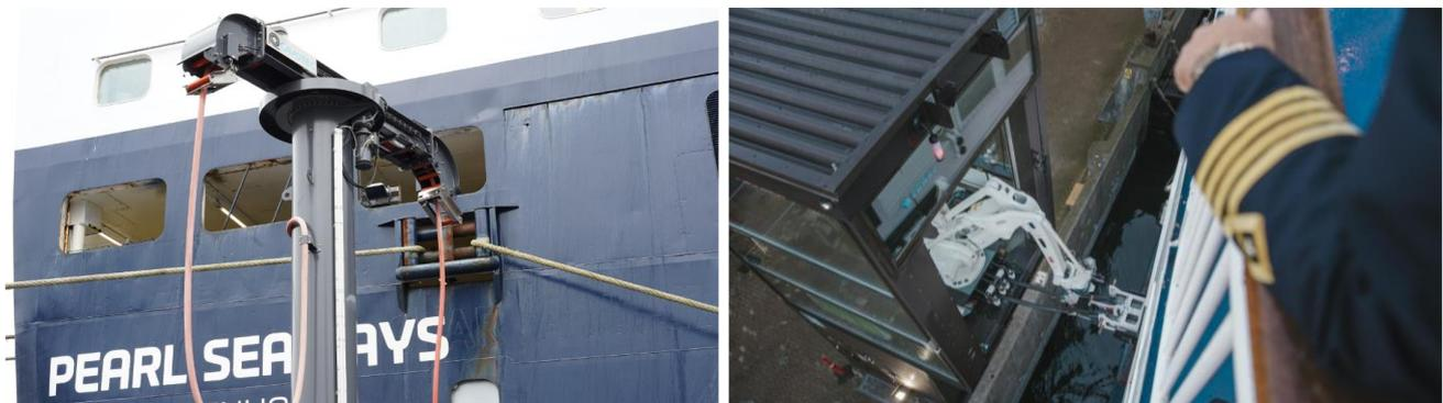
Figura 1. Ejemplos de dos brazos de conexión de sistemas OPS en Terminal.
