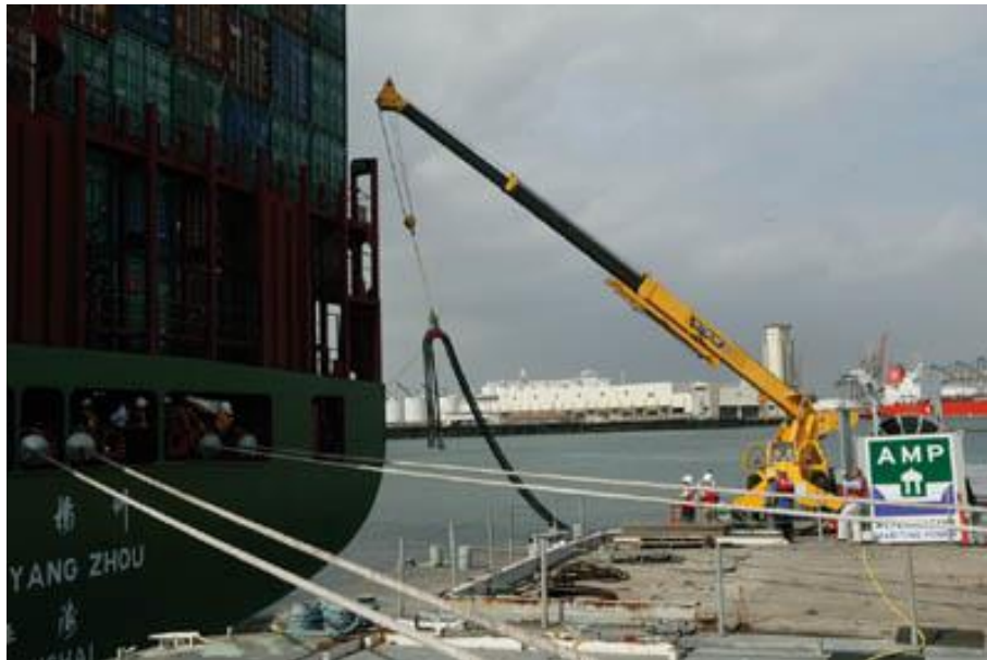
Figura 2.29 Ejemplo de grúa móvil para elevar los cables de conexión del sistema OPS desde barcaza en el muelle de Los Ángeles (Fuente: Port of Los Ángeles).
