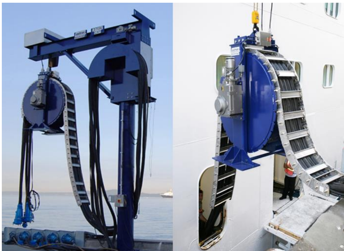
Figura 2.26 Ejemplo de grúa con base fija (izquierda) y operación de conexión de buque (derecha) (Fuente: Cochran Marine)
