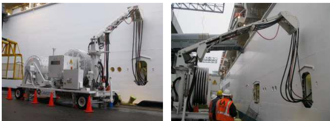
Figura 2.32 Grúa móvil para los cables del sistema OPS en el puerto de Los Ángeles desplegada (Fuente: Cavotec, AMP Mobile).
