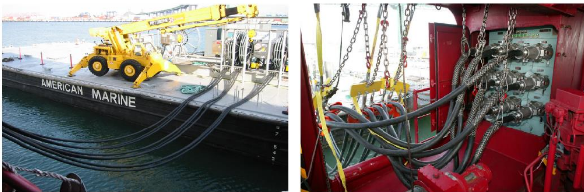
Figura 2.34 Conexión de los cables en buque en el puerto de Los Ángeles (Fuente: Ericsson, Fazlagic. 2008).
