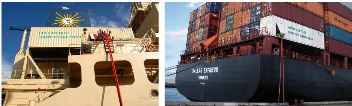
Figura 2.40 Sistema de conexión OPS en buque contenerizado de Wärtsila SAM Electronics.
