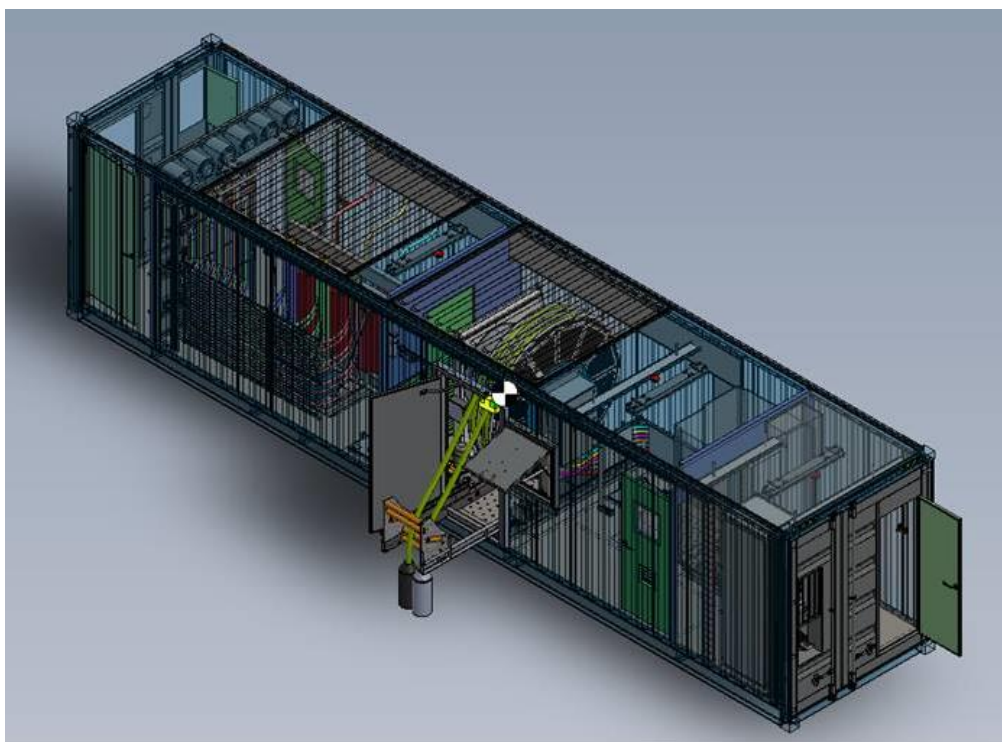
Figura 2.41 Diseño del contenedor con conexión OPS para buque portacontenedores (Fuente: Cavotec).
